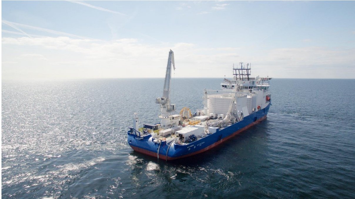
Figure 11 Navire utilisé pour la pose de câbles sous-marins (source : NKT)
