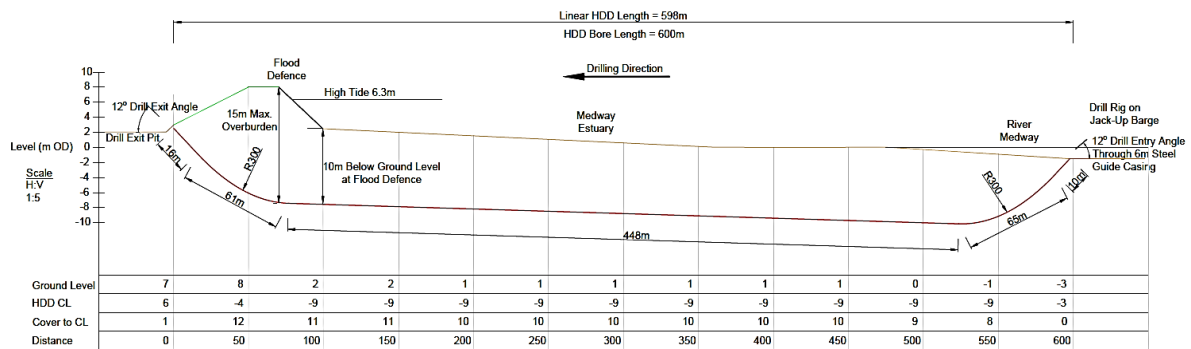
Figure 21 Vue schématique du franchissement du trait de côte en forage dirigé horizontal à Kingsnorth
