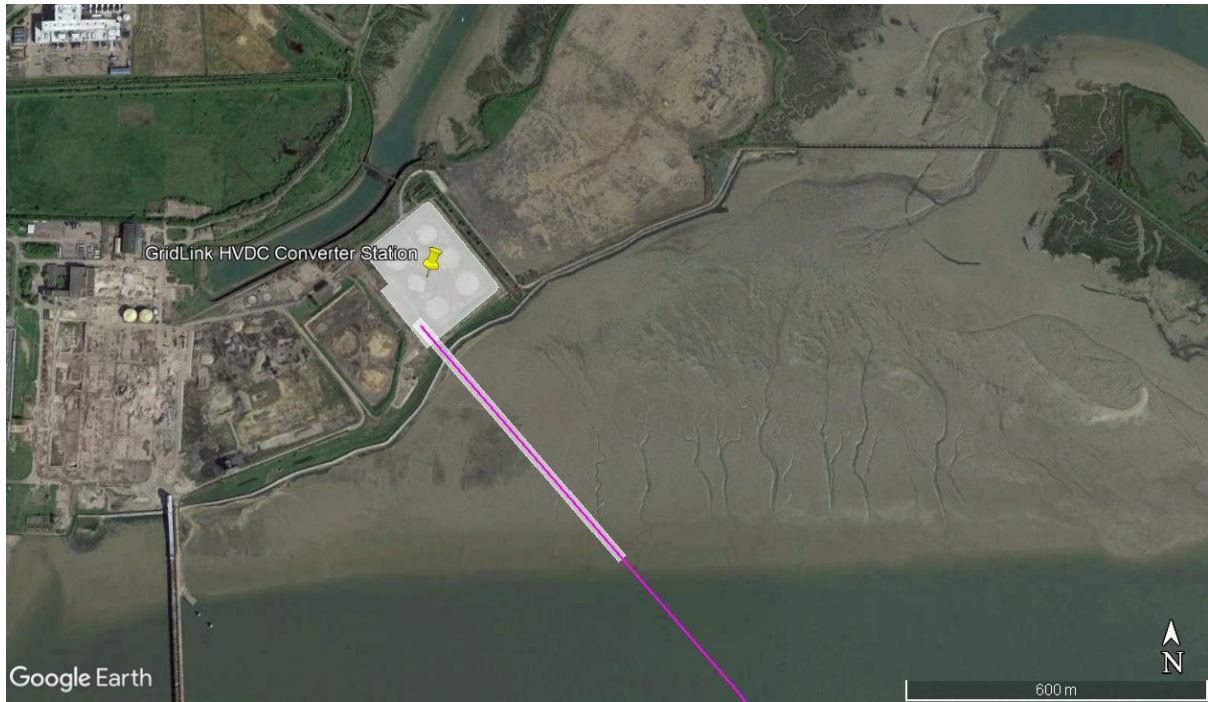
Figure 21 Vue schématique du franchissement du trait de côte en forage dirigé horizontal à Kingsnorth
